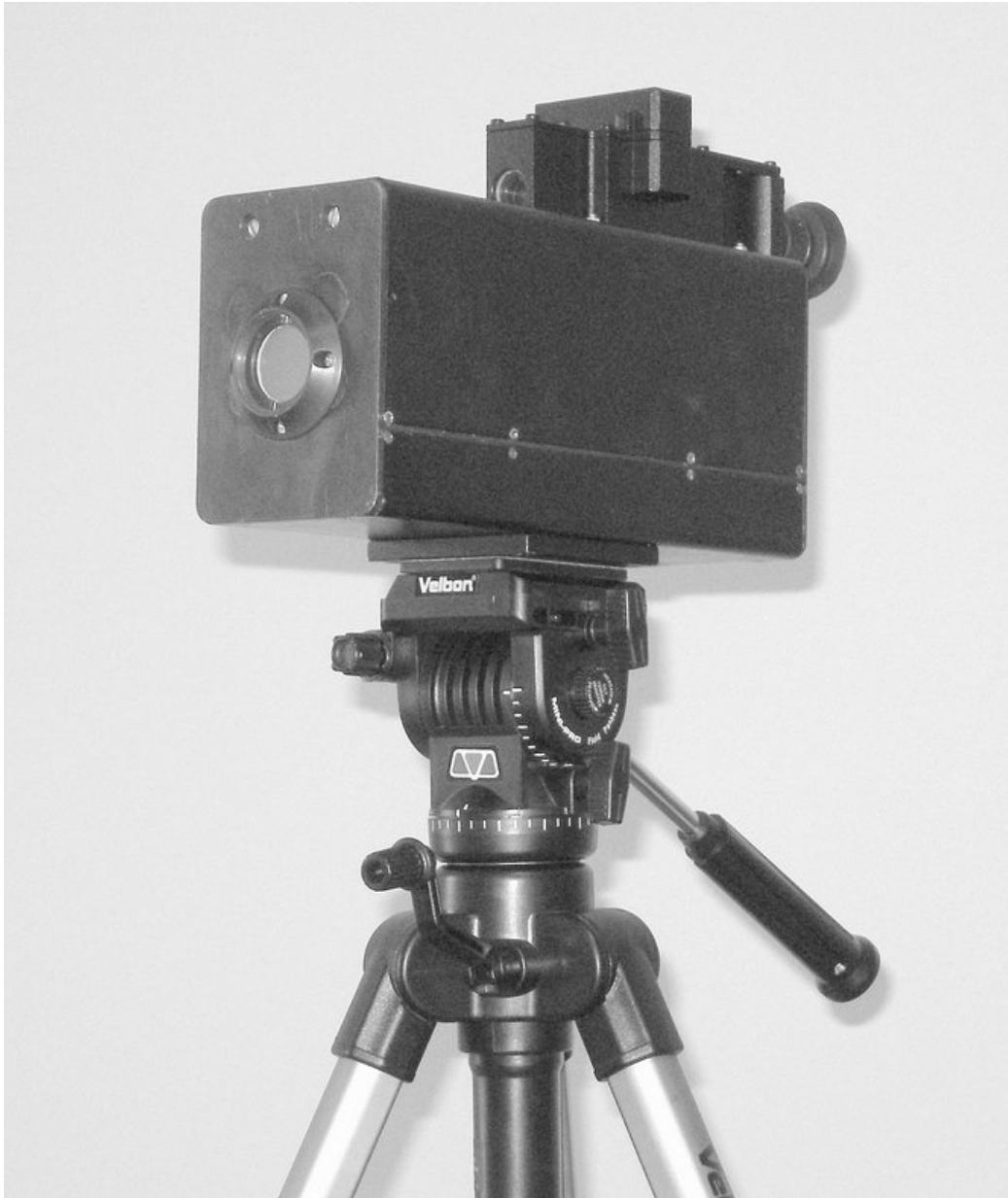
Рис.3. Общий вид портативного ФСР с неохлаждаемым пироэлектрическим фотоприемником.
