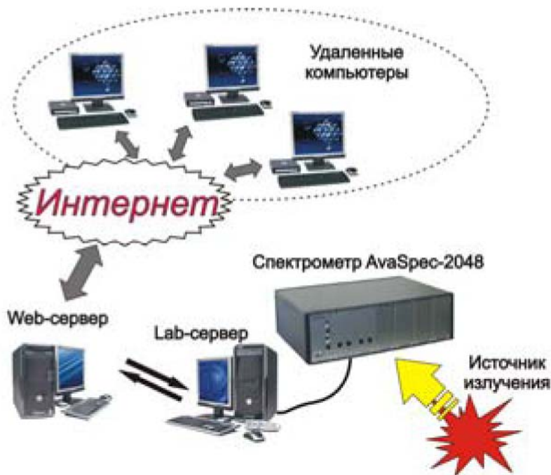
Рисунок 1. Схема проведения спектральной диагностики через глобальную сеть.
