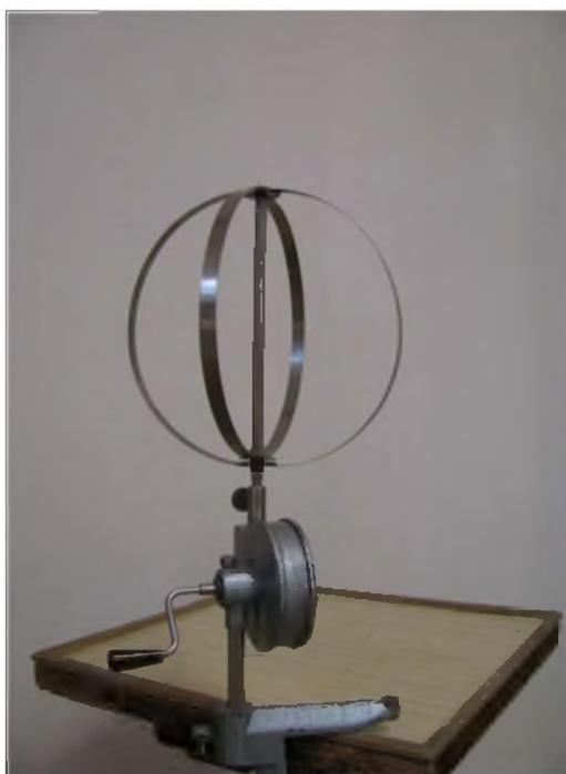
**Рисунок 2.** Инерционная машина, состоящая из упругих полосок.
