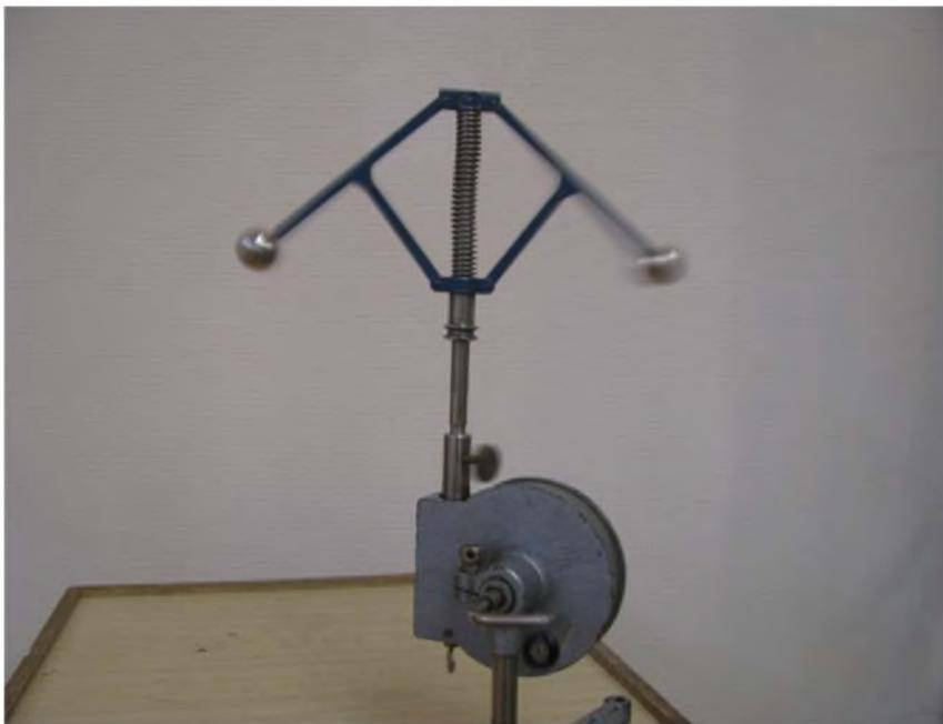
**Рисунок 1.** Механическая модель регулятора Уатта.
