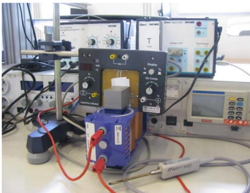
**Рисунок 5.** Установка для экспериментального исследования эффекта Холла в полупроводниках.
